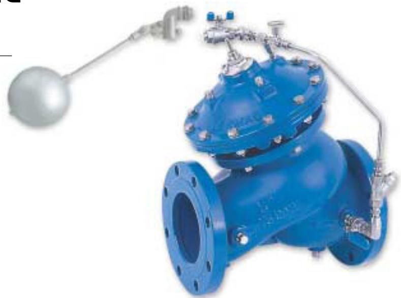
A Válvula de Controle de Nível Modelo 750-60 com boia horizontal de modulação é uma válvula controlada hidraulicamente, acionada por diafragma, que controla o abastecimento do reservatório para manter o nível de água constante, independentemente da demanda.
